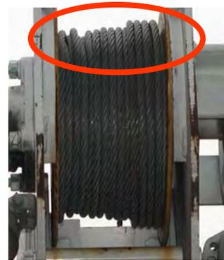
**POORLY SPOOLED WIRE ROPE CAN BE DAMAGED BY CRUSHING AND/OR SCUFFING**
